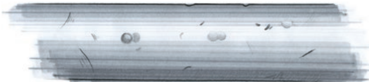
未经硬化处理的活塞杆
