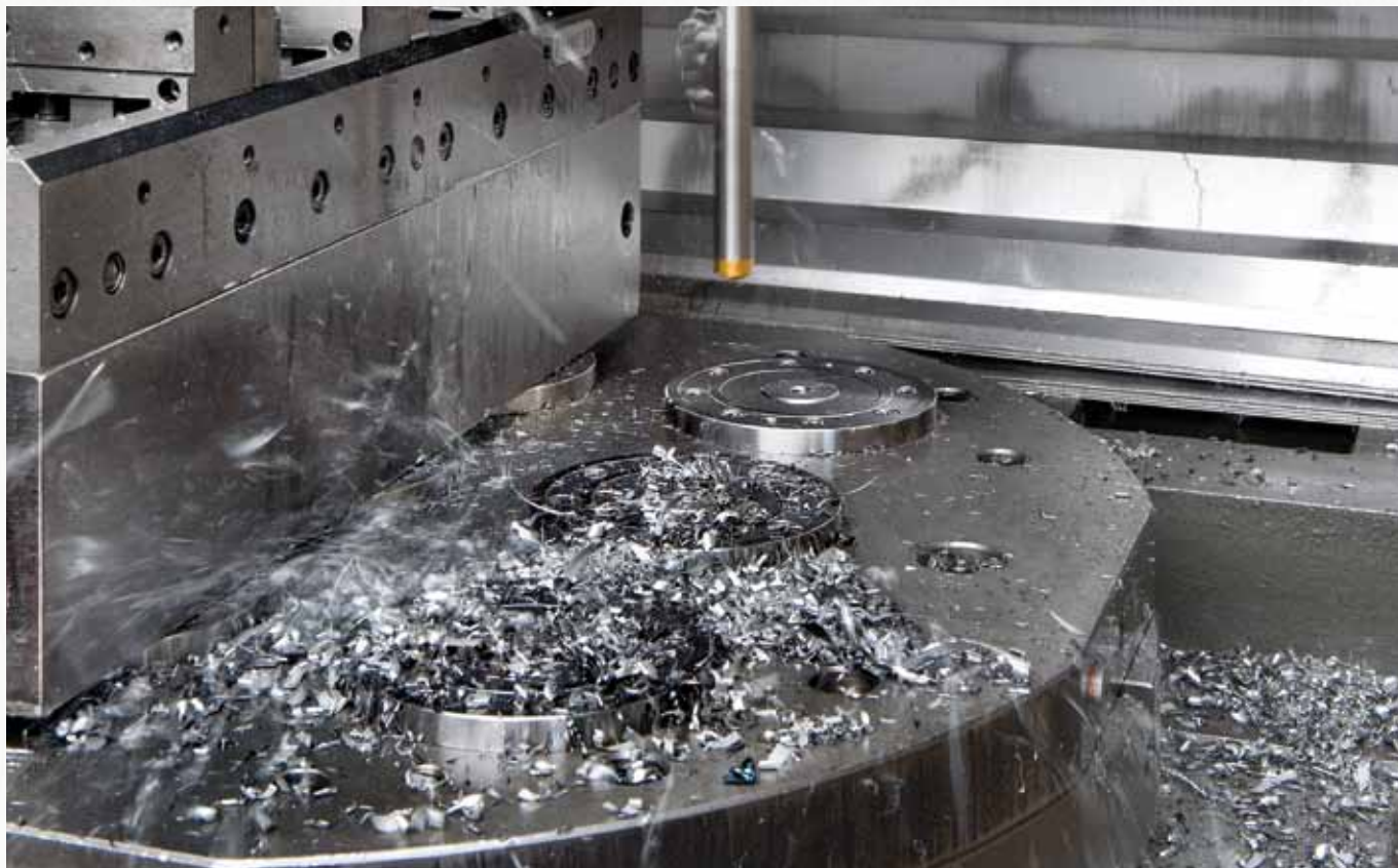
AMF-Clean-Stick em utilização: Limpeza automatizada de dispositivo de aperto e mesa da máquina
