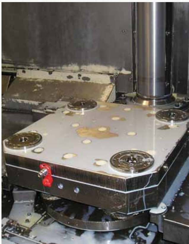
O compartimento interno do módulo é completamente vedado. Assim, o sistema está protegido da melhor maneira contra líquidos e impurezas.
